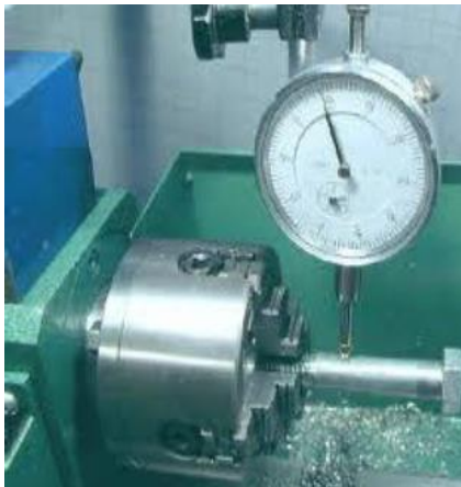
شكل رقم ١٣٢: استعمال ساعة القياس لفحص شغلة على آلة التشغيل
