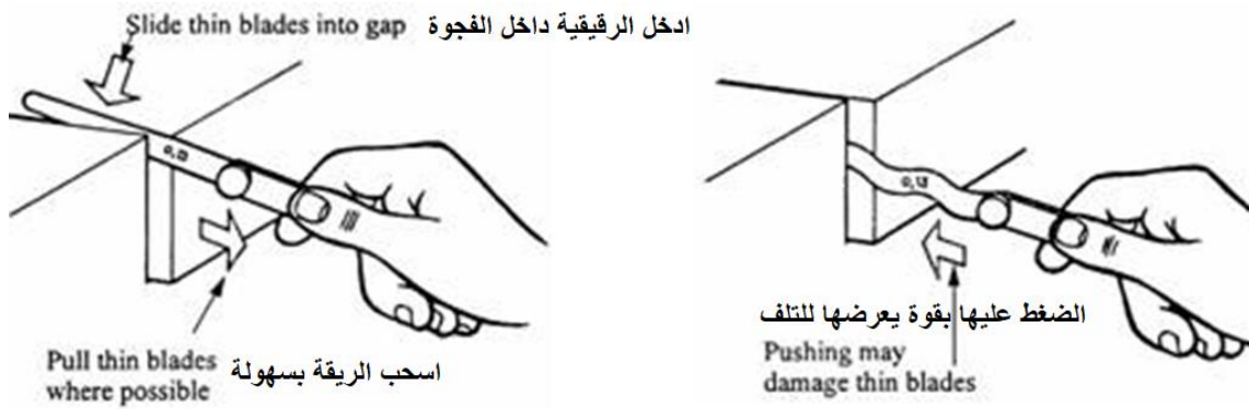
شكل رقم ١٨٨: الاستعمال الصحيح لل-filler
