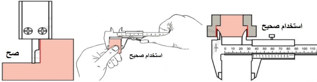
شكل رقم ٥٩: الاستخدام الصحيح عند إجراء عملية القياس
