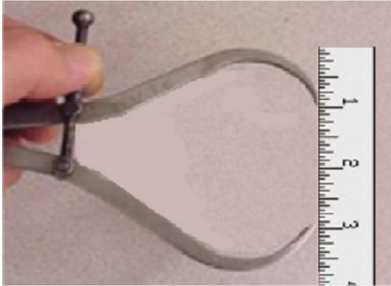
شكل رقم ٣٨: قراءة البعد الخارجي على المسطرة
