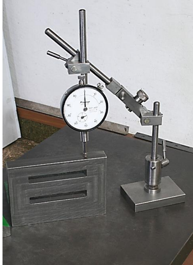
شكل رقم ١٣٤: فحص استواء سطح عدل
