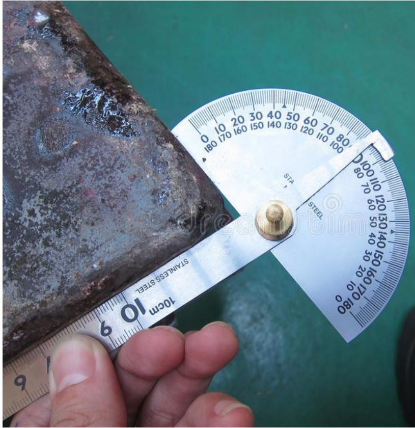
شكل رقم ١٢٣: القياس بالمنقلة البسيطة
